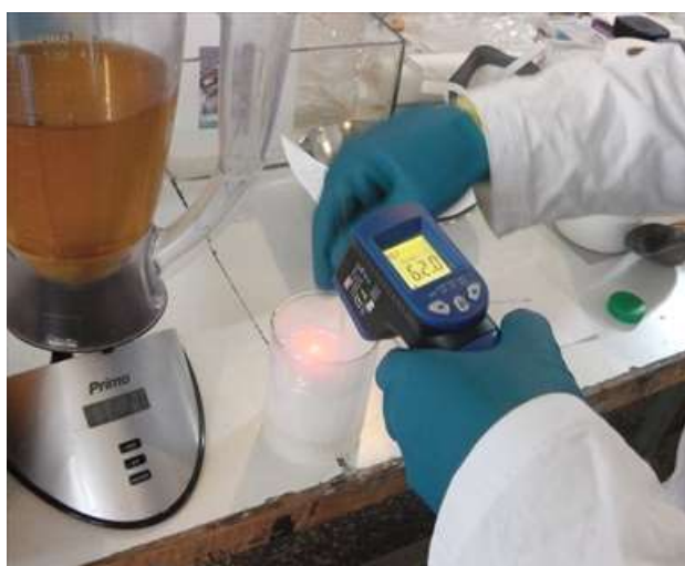
Διάλυση NaOH σε νερό (εξώθερμη αντίδραση)
