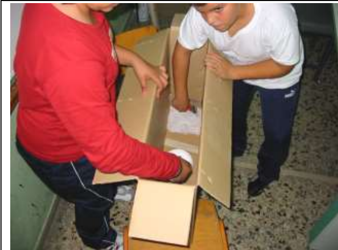
Φωτ. 3: Κολλάμε τον πάτο στην κούτα του συλλέκτη με 3-4 στρώσεις κυματιστό χαρτόνι ...
